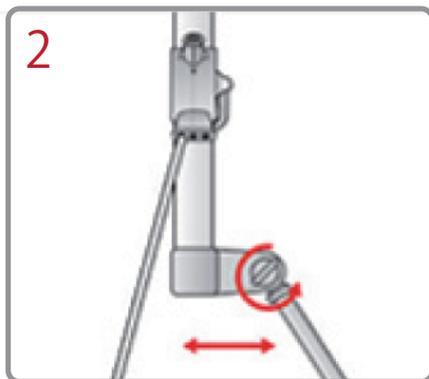
2 ポール下部後方の脚を付け根のビスを緩め角度を調整し、ビスを締めて固定します。
