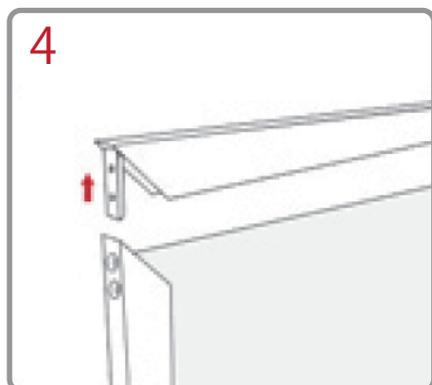
(印刷を取り付ける場合)フレームを外します。
