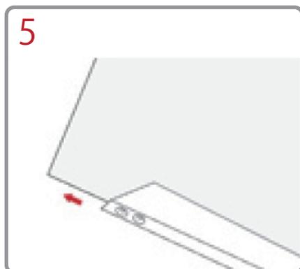
(印刷を取り付ける場合) パネルを外し、印刷を貼り付けます。外したのと逆の手順でフレームを戻します。
