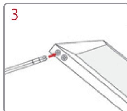
(印刷を取り付ける場合)パネル側面のビスを外します。
