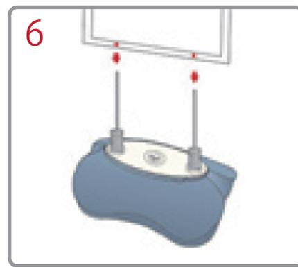
パネル下の穴にタンクに取り付けたポールの長い方を差し込み、完成です。
