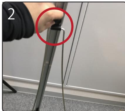
スタンド裏面の黒の丸いジョイントを回し、ネジをゆるめスタンドの角度を調節します。丁度良い角度になりましたら再びジョイントを逆に回し固定します。
