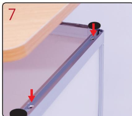
フレーム下部の黒いビスを手で回し全て外し、図の矢印で示したビスを付属の六角レンチを使い外し、下部アルミレールを取り外します。その後、パネルを引き抜いて下さい。元に戻す場合は逆の手順で行ってください。
