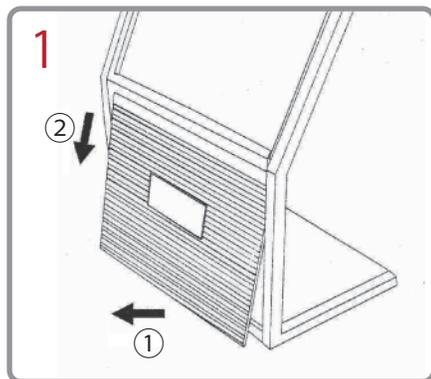
(下板に出力物を入れる場合)下板に手を添えていただき、本体を前方に倒していただくと下板が外れてきますので、図のように外します。
