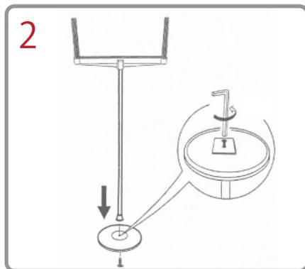
2 ポール下部のビスを付属のレンチで外し、ポールとベースを図のようにビスで固定します。
