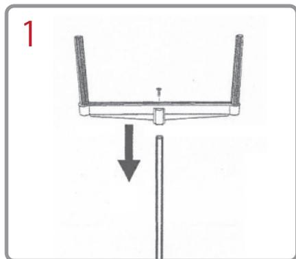
1 ポールのビスを付属のドライバーで外し、図のように面板を取り外したフレームをポールに差し込みます。その後、ポールから取り外したビスでフレームを固定します。
