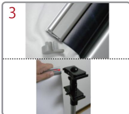
スクリーン上面のバーを装着する。バー片方の安全キャップを外す。ポール上部のバー取付部に挿入する。ポール下部も同様に行う。バー取付後、安全キャップを取り付ける。
