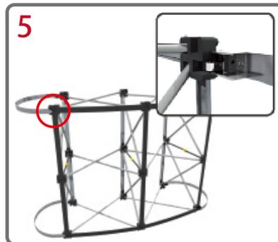
金属製のカーブバーを本体上下のマグネットに取り付けます。
